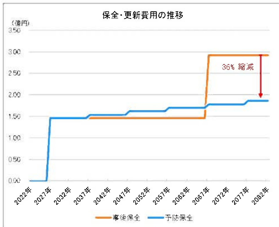
図-5 事後保全型（左）と予防保全型（右）に基づく維持管理概念図
